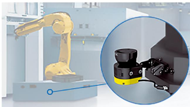
**Integração simples e rápida troca de dispositivo:** graças a inúmeros acessórios, memória de configuração integrada e componentes de conexão padronizados
