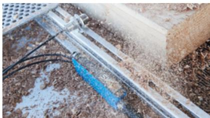
Adaptação contínua do valor limiar (CTA): sujeira existente na fibra óptica é compensada automaticamente. Dessa maneira, o sensor consegue realizar a detecção durante um tempo especialmente longo e sem manutenção, até mesmo de filmes transparentes ou de objetos muito complexos.
