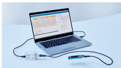
Parametrização remota rápida: configurações previamente definidas podem ser transmitidas via IO-Link para o WLL80.
