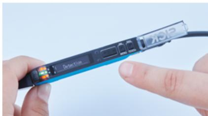
**Confortável:** os colaboradores podem regular as configurações do sensor diretamente na instalação – e recebem um feedback visual via display e pelos LEDs de status.
