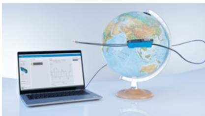
Regulagem da potência de transmissão (SPC): graças ao monitoramento e à regulagem posterior correspondente, o WLL80 mantém o sinal de luz enviado ao longo de toda a vida útil automaticamente num nível, visando um desempenho de detecção constantemente alto.
