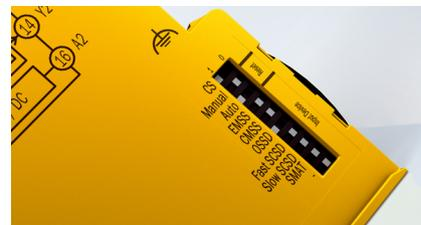
O relé multifuncional RLY3-MULT1 pode ser configurado por meio de um interruptor DIP e é adequado também para sensores de segurança complementares
