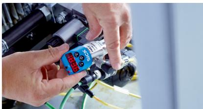
O sensor de pressão pode ser alinhado em praticamente todos os designs de máquinas na direção do operador, facilitando a operação e as condições de leitura.
