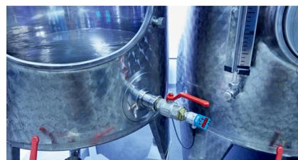
Alta precisão a partir de pressões de 0,4 bar tornam o dispositivo especialmente econômico para medições de nível hidrostáticas com pequenas colunas de água.
