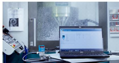
O PBS plus pode ser configurado de modo rápido e prático. O ajuste de parâmetros pode ser realizado de modo automatizado por meio de IO-Link.
