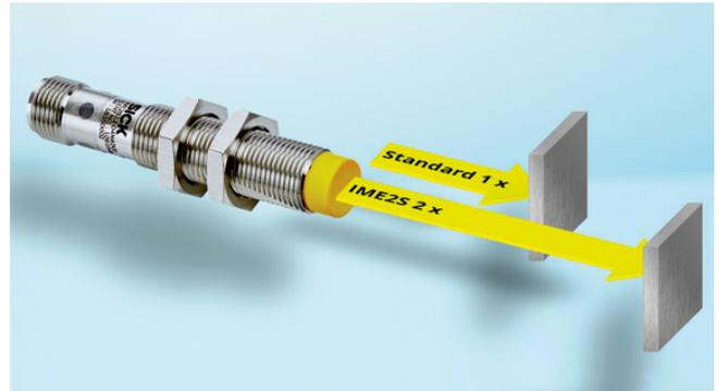
A menor variante da IME2S, com rosca M12, dispõe de uma distância de comutação única de 8 mm, sendo assim, é ideal para a detecção de peças móveis em máquinas pequenas.
