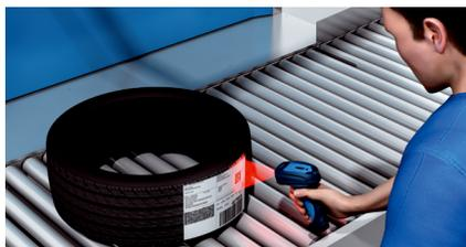
Identificação de pneus na automação fabril: alta confiabilidade graças ao grau de proteção industrial IP65 e à carcaça robusta.
