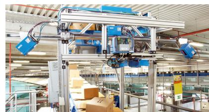
É possível integrar facilmente o PROFIBUS em grandes sistemas de rastreamento através do módulo de barramento de campo CDF600.
