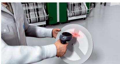
Identificação móvel de material de montagem de placas. Rápida identificação do código, seja qual for a posição de giro, graças à câmera de matriz integrada.
